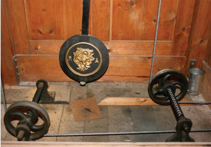
Deux câbles, l'un pour le temps, l'autre pour la cloche, transportent l'énergie nécessaire et le balancier régule le tout.
