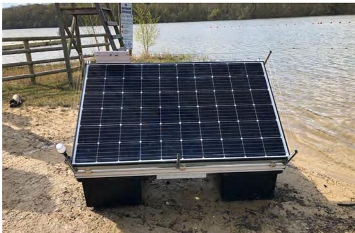
Toutes les algues ont une fréquence de résonance critique à laquelle elles subissent des dommages ; les fréquences des appareils sont réglées pour égaler la fréquence de résonance de la membrane cellulaire des algues, endommageant celles-ci de façon fatale dans les 72 heures de contact.
