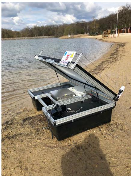
leurs vacuoles qui sont endommagées, des microcellules de gaz qui permettent leurs déplacements verticaux dans la colonne d'eau et régissent les fonctions vitales. Ainsi, les ultrasons provoquent l'implosion des vacuoles, entraînant la cellule dans les profondeurs et réduisant de façon fatale le processus de photosynthèse. Les humains, les animaux, les poissons et les plantes ont des fréquences de résonance différentes et ne sont donc pas affectés par les ultrasons émis par les transducteurs.
